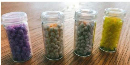
LDPE Masterbatches mit integrierten Leuchtstoffen
